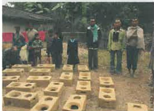
Diese kleinen Küchenherde aus Ton können vor Ort einfach selbst produziert werden. Sie helfen, den Brennholzverbrauch zu reduzieren.
